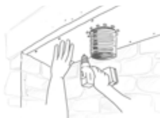
Positionnement de la plaque en partie basse du conduit mandriné
