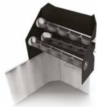
La **PREMIÈRE PARTIE** de l'échangeur est composée de 3 tubes à l'intérieur desquels des spirales hélicoïdales garantissent la rotation de l'eau à l'intérieur des passages. Ce détail permet au fluide caloporteur de suivre un trajet plus long et avec une vitesse majeure, augmentant ainsi le rendement thermique.
