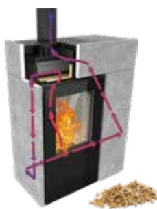
En mode pellet, le volet des fumées dévie vers l'échangeur pellet et l'extracteur des fumées, pour favoriser un rendement optimal et une combustion parfaite.
