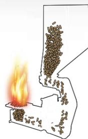
POÊLE ÉQUIPÉ DE TECHNOLOGIE BREVETÉE **DIELLE** DE CHARGEMENT DU PELLET PAR LE BAS
